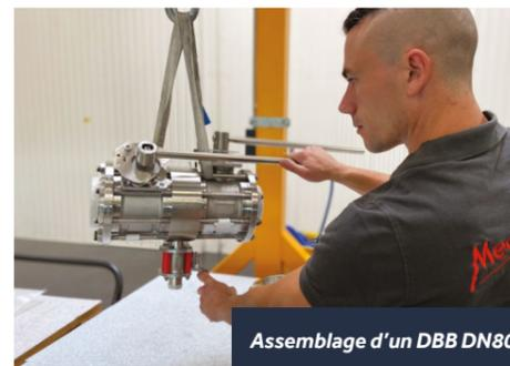
Assemblage d'un DBB DN80
