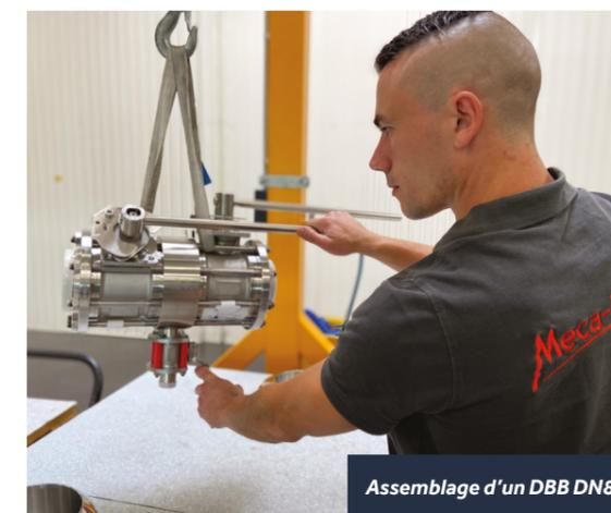
Assemblage d'un DBB DN80
